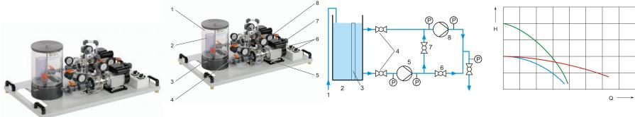
Dans des installations complexes, il est possible d'utiliser des pompes montées en série ou en parallèle.
