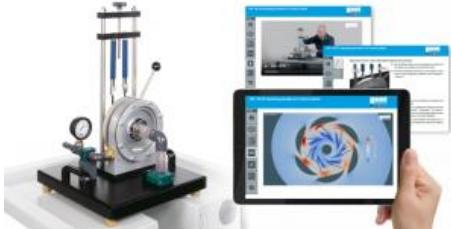
La turbine Francis fait partie des turbines à réaction qui transforment l'énergie de pression de l'eau en énergie cinétique dans le distributeur et dans le rotor.
