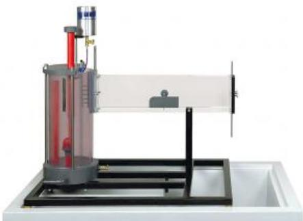
Le banc dessai HM 150.21 permet de visualiser les écoulements autour de corps de résistance et les phénomènes découlement dans des canaux ouverts.
