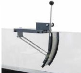
Les vannes radiales font partie des ouvrages de contrôle mobiles; l'écoulement les traverse par dessous. L'élément principal de la vanne radiale est une paroi ayant la forme d'un segment circulaire qui produit une retenue dans un canal traversé par un écoulement.
