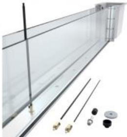
Les jetées ou les plateformes de forage sont en général construites sur des pilotes situés dans leau. Leau en écoulement exerce des forces sur la partie des pilotes se trouvant sous la surface de leau, ce qui peut provoquer des oscillations.
