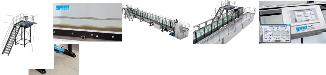
L'alimentateur en sédiments est constitué principalement d'une goulotte d'alimentation vibrante qui dépose les sédiments dans la section d'essai du HM 161.
