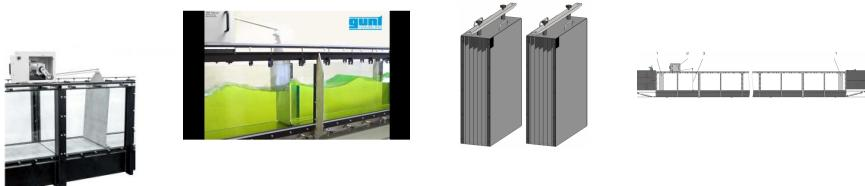
Les vagues de surface sont générées par une plaque de refoulement qui exécute un mouvement pivotant. La plaque est entraînée par un moteur avec convertisseur de fréquence par le biais d'un système bielle-manivelle.
