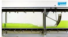
Les vannes radiales font partie des ouvrages de contrôle mobiles; l'écoulement les traverse par dessous.
