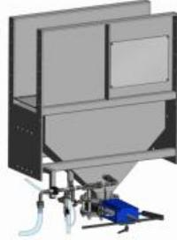
**les sédiments sont retirés manuellement du piège et rapportés au niveau de l'alimentateur**
