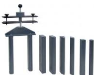
Les obstacles présents dans le canal réduisent la section d'écoulement.
