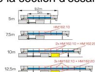
Le réservoir d'eau MH 162.20 est nécessaire en cas d'extension du canal dessai à une longueur de section dessai supérieure afin que la quantité d'eau disponible soit toujours suffisante.
