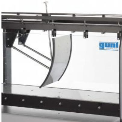
Les vannes radiales font partie des ouvrages de contrôle mobiles; l'écoulement les traverse par dessous. L'élément principal de la vanne radiale est une paroi ayant la forme d'un segment circulaire qui produit une retenue dans un canal traversé par un écoulement.
