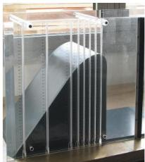
Les déversoirs à crête arrondie sont des déversoirs fixes qui font partie des ouvrages de contrôle. Ils sont souvent utilisés pour retenir les eaux d'une rivière.
