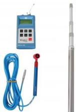
L'élément principal du tachymètre HM 163.64 est une roue à ailettes qui tourne sous l'effet de l'écoulement.
