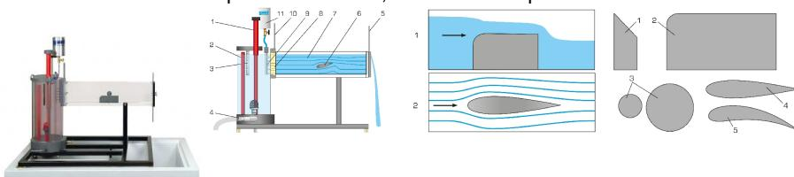
Le banc dessai HM 150.21 permet de visualiser les écoulements autour de corps de résistance et les phénomènes découlement dans des canaux ouverts.
