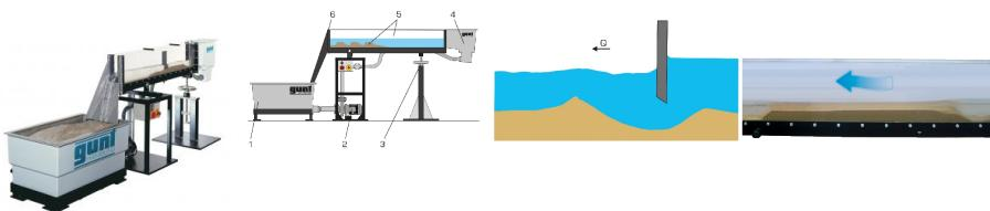
Avec HM 140, des phénomènes importants du transport par charriage dans la zone proche du lit sont montrés en se servant du sable comme exemple.
