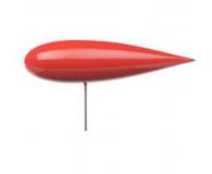
Le corps de résistance corps de ligne de courant est étudié dans la section de mesure de la soufflerie HM 170. Le corps de résistance se compose d'un corps de ligne de courant et d'une barre de maintien en acier inoxydable. Le corps de ligne de courant est peint en rouge.
