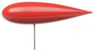
Le corps de résistance corps de ligne de courant est étudié dans la section de mesure de la soufflerie HM 170. Le corps de résistance se compose d'un corps de ligne de courant et d'une barre de maintien en acier inoxydable. Le corps de ligne de courant est peint en rouge.
