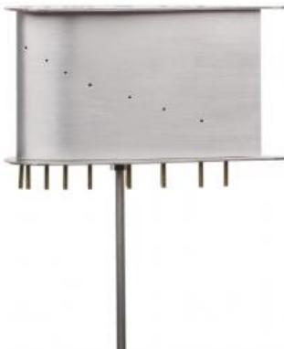
HM 170.26 avec profil d'aile NACA 54118 permet - en liaison avec la soufflerie HM 170 - d'enregistrer la distribution de la pression.
