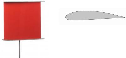
Le corps de portance aile est étudié dans la section de mesure de la soufflerie HM 170.
