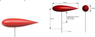
Le corps de résistance corps de ligne de courant est étudié dans la section de mesure de la soufflerie HM 170. Le corps de résistance se compose d'un corps de ligne de courant et d'une barre de maintien en acier inoxydable.
