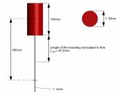
Le corps de résistance cylindre est étudié dans la section de mesure de la soufflerie HM 170.
