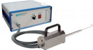
Pour visualiser l'écoulement, le générateur de brouillard HM 170.52 produit un brouillard particulièrement dense en évaporant un mélange de glycol liquide.
