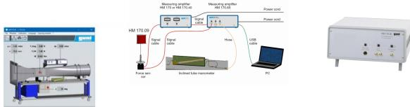
Le système d'acquisition des données a été spécialement mis au point pour simplifier l'analyse des essais réalisés avec la soufflerie HM 170.
