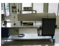
Le modèle HM 170.23 sert à déterminer la distribution de pression sur un cylindre soumis à un écoulement autour de corps.
