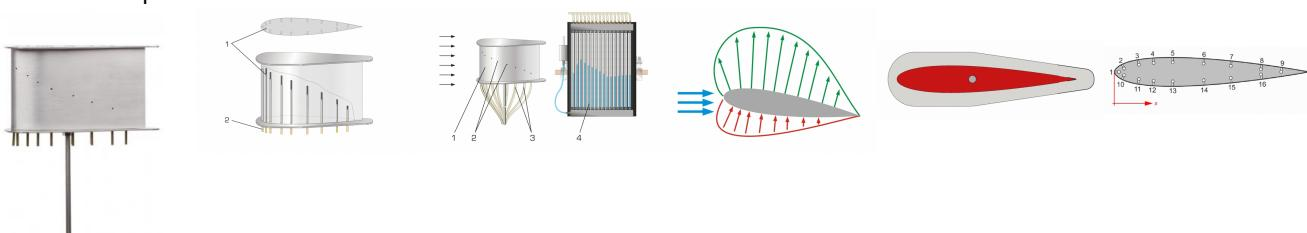
La mesure de la répartition de la pression sur un profil d'aile soumis à un écoulement autour de corps délivre aux étudiants les notions de base sur la génération de la portance effective d'une aile.
