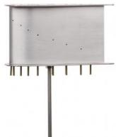
HM 170.27 avec profil d'aile NACA 4415 permet - en liaison avec la soufflerie HM 170 - d'enregistrer la distribution de la pression.
