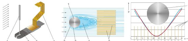
Lorsque des profils de corps sont soumis à un écoulement autour de corps, on assiste à la formation d'écoulements sur la couche limite.
