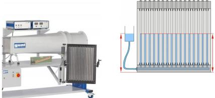
Le manomètre HM 170.50 sert à indiquer simultanément jusqu'à 16 pressions différentielles mesurées en millimètres de colonne d'eau.
