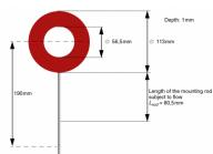
Le corps de résistance anneau de cercle est étudié dans la section de mesure de la soufflerie HM 170. Le corps de résistance se compose d'un anneau de cercle en tôle d'acier et d'une barre de maintien en acier inoxydable.
