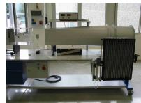
Le modèle HM 170.23 sert à déterminer la distribution de pression sur un cylindre soumis à un écoulement autour de corps.
