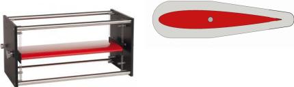
Le modèle à aile est suspendu de façon flexible dans un châssis externe à l'aide de huit ressorts.
