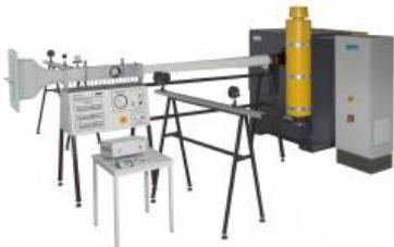
Les écoulements subsoniques et les écoulements supersonique ne se comportent pas de la même manière. Ainsi, un étranglement de la coupe transversale de l'écoulement subsonique entraîne une augmentation de la vitesse, alors que sur l'écoulement supersonique, on observe une réduction de la vitesse.
