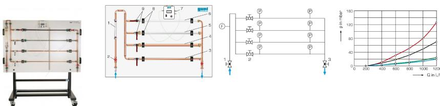
Dans des tuyaux traversés par un écoulement, des pertes de charge ont lieu suite au frottement entre les parois du tuyau et l'eau.
