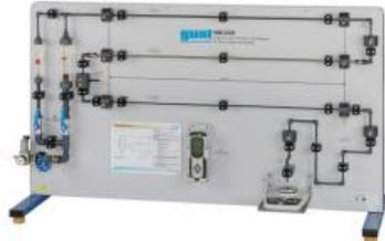
Dans des tuyaux traversés par un écoulement, des pertes de charge ont lieu suite au frottement entre les parois du tuyau et le fluide.
