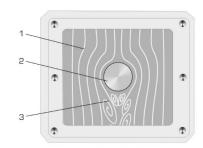
Évalution d'écoulement d'un cylindre soumis à un écoulement autour de corps: 1 lignes de courent, corps de résistance, 3 décollement de l'écoulement evec tourbillons
