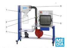
1 busa, 2 section de mesure à monter, 3 thermomètre, 4 tuyau d'air extrait, 5 ventilateur radial, 6 manomètre à tubes, 7 coffret de distribution avec ajustage de la vitease, 8 chambre de stabilise tion avec redresseur d'écoulement
