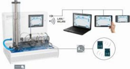
Dans le cas d'un écoulement horizontale d'un réservoir, la forme de la sortie et la vitesse de l'écoulement agissent sur la trajectoire du jet d'eau.
