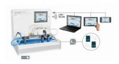
Laccessoire HM 250.07 est utilisé pour étudier la relation entre la vitesse découlement dun fluide et sa pression dans une buse Venturi.
