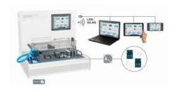
Lappareil dessai HM 250.11 est utilisé pour démontrer les effets produits par différents obstacles sur la hauteur dénergie dans des écoulements dans des canaux.
