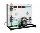
Sur les turbines à impulsion, le milieu de travail a la même pression statique avant et après le rotor. La conversion de lénergie de pression en énergie cinétique a lieu dans les buses fixes du distributeur et non dans le rotor de la turbine. Lappareil dessai à air comprimé permet de comprendre les analogies qui existent avec les turbines à vapeur ou hydrauliques.
