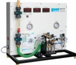
Sur les turbines à impulsion, le milieu de travail a la même pression statique avant et après le rotor. La conversion de l'énergie de pression en énergie cinétique a lieu dans les buses fixes du distributeur et non dans le rotor de la turbine. L'appareil d'essai à air comprimé permet de comprendre les analogies qui existent avec les turbines à vapeur ou hydrauliques.
