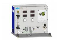
Sur les turbines à réaction, la pression statique du milieu de travail est plus élevée devant que derrière le rotor. Sur les turbines exclusivement à réaction dont le degré de réaction est de un, la totalité de lénergie de pression est convertie en énergie cinétique.
