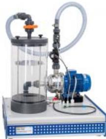
**HM 290 Unité d'alimentation pour turbines Pelton, à réaction, à action (Réf. 070.29000)**
