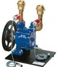
Les pompes à canal latéral sont à classer entre la pompe volumétrique et la pompe d'écoulement.
