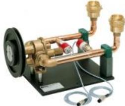
La pompe à engrenages se distingue par son débit de refoulement homogène.
