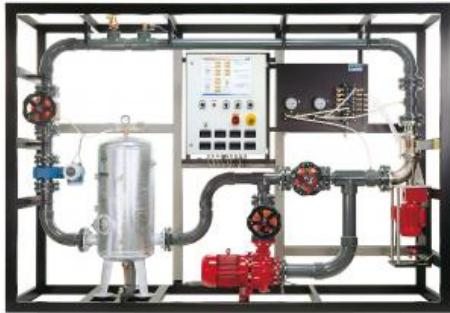
L'élément central de l'installation d'essai est la turbomachine axiale avec moteur asynchrone accouplé. Elle peut être utilisée au choix comme pompe ou comme turbine.
