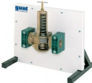
**HM 700.08 Modèle en coupe soupape de réduction de pression (Réf. 070.70008)**
