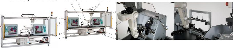
Le système didactique IA 520 présenté ici représente une cellule de fabrication entièrement opérationnelle, également appelée cellule CIM (CIM = Computer Integrated Manufacturing).
