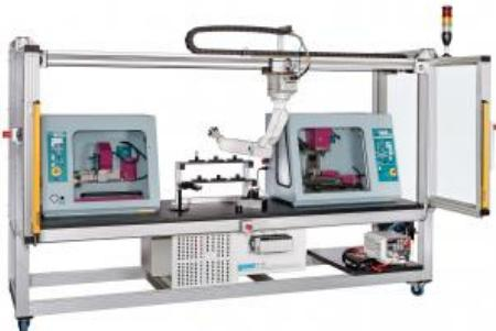
Le système didactique IA 520 présenté ici représente une cellule de fabrication entièrement opérationnelle, également appelée cellule CIM (CIM = Computer Integrated Manufacturing).
