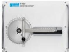
Contrairement au mécanisme bielle-manivelle normal, le mécanisme à coulisse produit un mouvement de translation purement harmonique.
