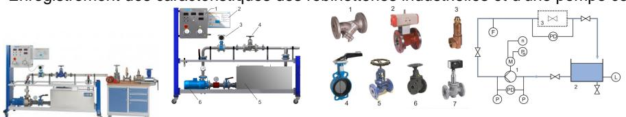
Le banc dessai RT 396 permet la comparaison de différentes robinetteries du point de vue de leurs caractéristiques. Les quatre catégories typiques de robinetteries, robinet, robinet-vanne, clapet et soupape sont représentées par un robinet à tournant sphérique, un clapet, un robinet-vanne, une soupape d'arrêt et une vanne de régulation. On examine en outre une soupape de sécurité et un collecteur d'impuretés.
