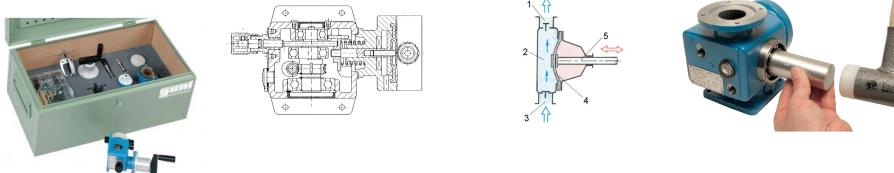
Les pompes à diaphragme font partie des pompes volumétriques et fonctionnent par oscillation, à aspiration normale.
