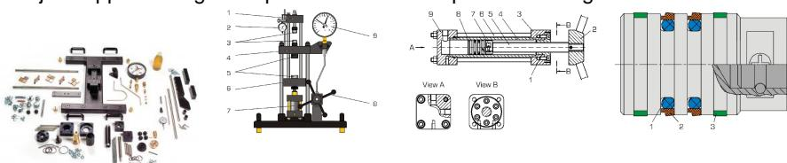
Le MT 190 est livré sous la forme d'un kit d'assemblage, et comprend toutes les pièces de montage mécanique, instruments de mesure, composants hydrauliques avec éléments détachés, ainsi que le matériel de tuyauterie avec toutes les pièces de raccordement.
