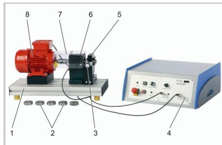
1 plaque de fondation, 2 palier à roulement, 3 dispositif de charge, 4 appareil de commande, 5 accueil du palier à étudier, 6 logement de l'arbre, 7 couvercle transparent, 8 moteur
