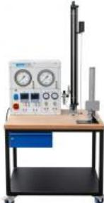
Le banc détalonnage permet d'étudier les caractéristiques de transfert des composants électriques et pneumatiques de la boucle de régulation, tels que les transducteurs de mesure et les vannes de régulation.
