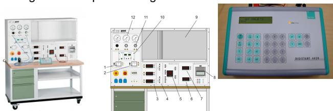
La station détalonnage permet d'étudier les caractéristiques de transfert des composants électriques et pneumatiques de la boucle de régulation.
