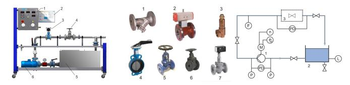
Robinetheries fournis: 1 collecteur d'impuretés, 2 robinet à tournant sphérique, 3 soupape de sécurité, 4 clapet, 5 soupape d'arrêt, robine. 2 réservoir, 3 robineteries à lester, capteurs: E puissance, F débit, L niveau, P pression, FD pression différentelle, n vitesse d'
