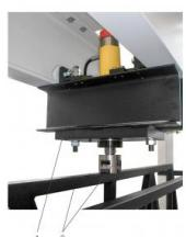
Cet accessoire pour SE 100 comprend un dispositif de charge à entraînement hydraulique.
