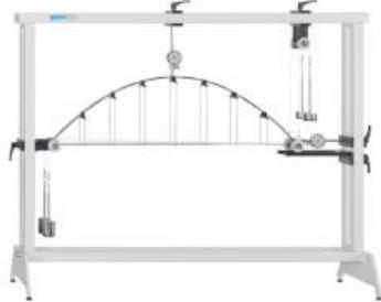
**Différences entre un arc isostatique et l'arc hyperstatique, Nécessite bâti SE 112**
