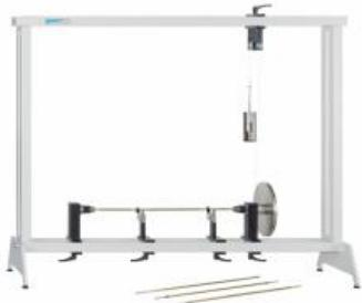
La torsion apparaît avant tout au niveau des axes et des arbres entraînement des véhicules et des machines. Les sections de l'arbre sont poussées l'une contre l'autre autour de l'axe longitudinal en raison des couples de rotation de l'arbre.
