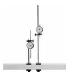
Ce jeu de comparateurs à cadran mécaniques permet de mesurer avec précision les déplacements mécaniques avec de nombreux montages expérimentaux.
