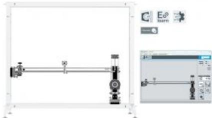
La torsion se produit principalement sur les essieux et les arbres de transmission dans les véhicules et les machines. Les moments de torsion qui se produisent dans l'arbre font que les coupes transversales de l'arbre se déplacent les unes par rapport aux autres autour de l'axe longitudinal.
